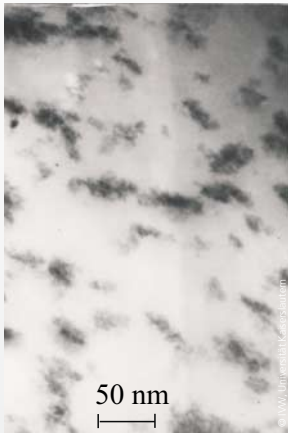
Transmissionselektronenmikroskopische Aufnahme (links) einer gleichmäßigen Verteilung von Agglomeraten aus den 7 nm großen \text{SiO}_2 Partikeln in der Polypropylenmatrix und raster-sondenmikroskopische Darstellung der feinen Partikel in einem dieser Agglomerate (rechts)
