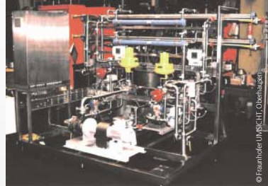
Mobile Ultrafiltrationsanlage zur Vor-Ort-Aufbereitung von Prozesswässern
