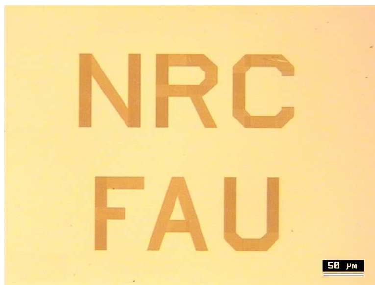
Mit fokussiertem Ionenstrahl implantiertes und elektrochemisch angeätztes Muster
