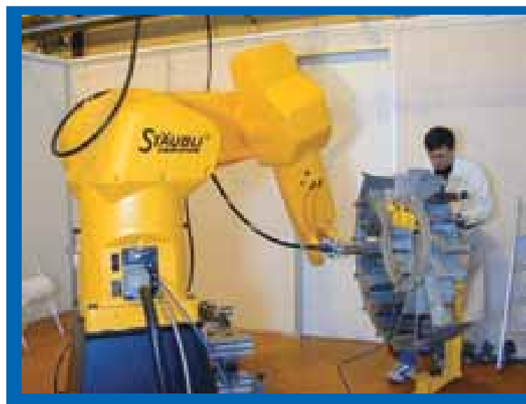
Développement du procédé laser pour la réparation de composants de réacteurs pour le fabricant de propulseurs français, la SNECMA
