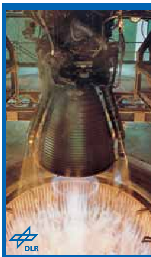
Test du principal étage du moteur « Vulcain 2 » d'ARIANE 5 au banc d'essai du site de Lampoldshausen du DLR
